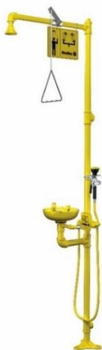
exige que les douches oculaires et les douches d'urgence projettent de l'eau tiède (15,5 à 37,7 °C/60 à 100 °F) pendant 15 minutes. Un mitigeur thermostatique conçu pour les appareils d'urgence est nécessaire pour mélanger l'eau chaude et l'eau froide. Les MT
